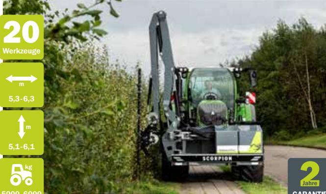
Mit dem Scorpion Basic Front hat GreenTec eine komplette Auslegemäher-Serie entwickelt, die das Hydrauliksystem des Traktors oder Laders als einzige Energiequelle nutzt.
