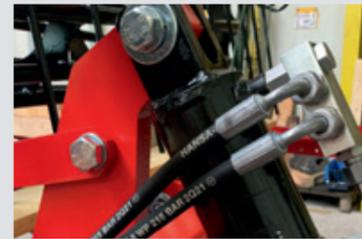
Hydraulische Arbeitstiefeneinstellung mit Sperrblock
